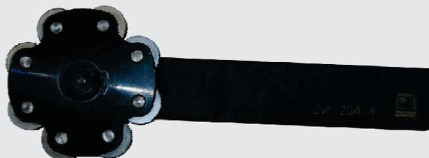
Les outils de moletage de tête rotative reprennent toutes les caractéristiques des outils de moletage de modèle standard plus un élément important supplémentaire: ces outils sont équipés de quatre paires de molettes; tout ce qui peut être instantanément appliqué sur la pièce. Pas de temps perdu à changer de molettes. Meublé avec des molettes à motif de diamant de type presse de style standard, à pas fins et grossiers.
